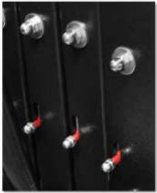
Sistema de desbloqueo de los tramos (MSU)
