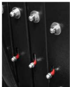
Sistema de desbloqueo de los tramos (MSU)
