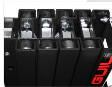
Sistema de reenvío con poleas de acero.
